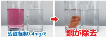
水道水にPDP試薬を入れ、ピンク色の濃さにより塩素濃度を調べる実験。銅を入れると除去。
