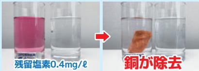
水道水にPDP試薬を入れ、ピンク色の濃さにより塩素濃度を調べる実験。銅を入ると除去。
